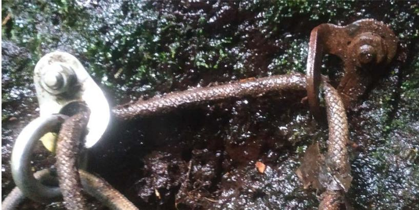
Ici un relais avec deux points reliés : un point oxydé (à Droite) Marque **FIXE** en bi-chromaté, (non-concerné par la rupture sous contrainte) et l'autre **INOX A4 Raumer** (à Gauche).
