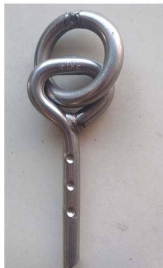
Ici, une broche collée (très mal d'ailleurs !!!) en **INOX** de marque **FIXE** en diamètre 10 comme le modèle en incrustation. On peut y voir apparaître de l'oxydation au niveau de la soudure et du corps.
